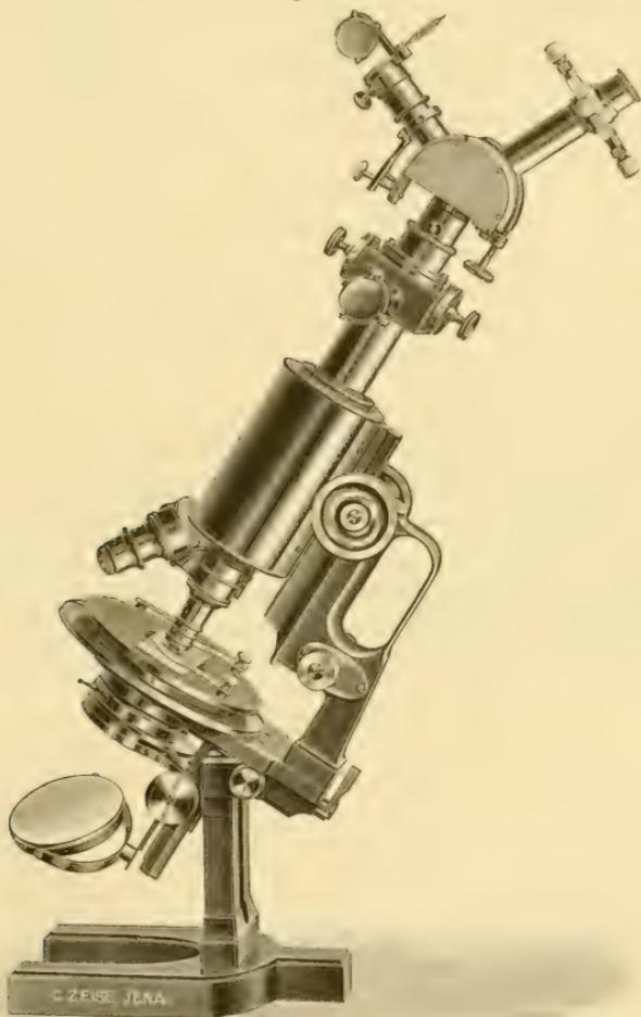
Fig. 1 zeigt das eigentliche Photometer in  $\frac{2}{3}$  natürlicher Grösse. Auf dem Spaltkopf *A* sitzt justirt durch die Anschlagsschrauben *H* das Obertheil, bestehend aus einer flachen halbcylindrischen Büchse *B*, dem Beobachtungfernrohr *C* und Scalenrohr *D*. Die Büchse enthält das Transparentgitter nach THORP. Das Fernrohr kann durch Drehen der Schraube *E* über das Spectrum hinweg bewegt werden. Die vier
