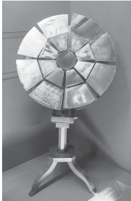
Abb. 1: Miroir à foyer variable (Brennspiegel), 1741. Konstruiert von Charles auf Anweisung von Buffon.
