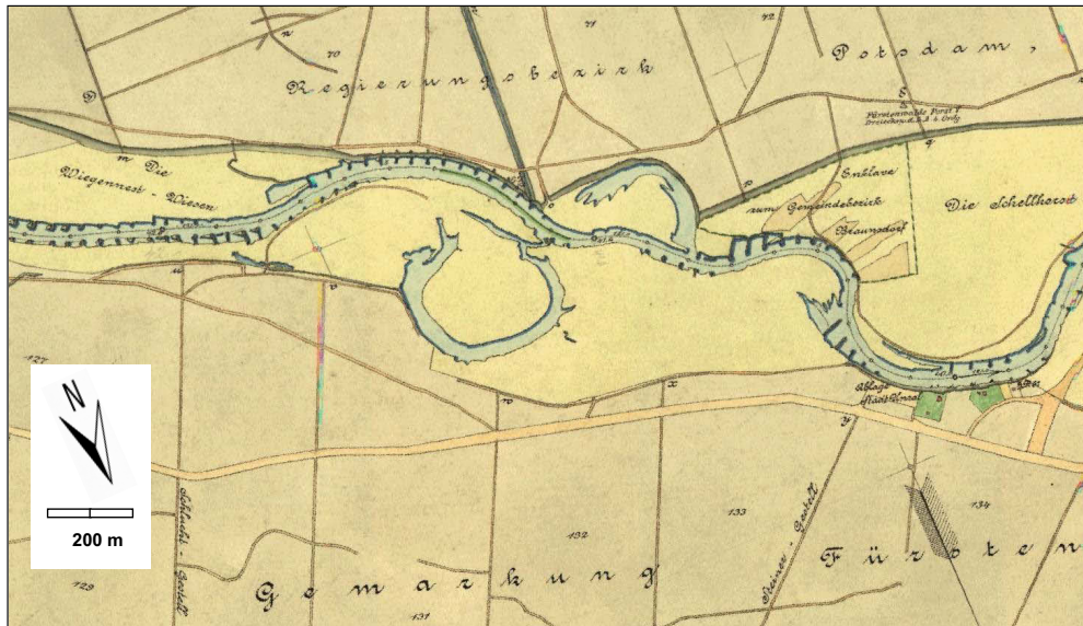
Fig. 5 River training of the “Müggelspree” section of the Spree west of Fürstenwalde. The groynes represented along the river course aimed to stabilise river margins, to confine the navigable water, and thus to increase usable depth for the barge traffic that passed the river section until 1890. Extract from Kartenwerk Müggelspree by Wasserbaudirektion Kurmark of 1921 (Survey 1916/17), Wasser- und Schifffahrtsamt Berlin / Flussverlauf der „Müggelspree“ westlich von Fürstenwalde. Die Buhnen dienen zur Stabilisierung des Flusslaufes und sollten seit 1890 die Befahrbarkeit mit Binnenschiffen sichern. Auszug aus dem Kartenwerk Müggelspree der Wasserbaudirektion Kurmark von 1921 (Ausgabe 1916/17), Wasser- und Schifffahrtsamt Berlin
