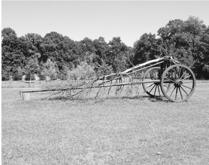
2 Rekonstruktion einer »Baummaschine« nach Hermann Fürst von Pückler-Muskau für den Transport und das Verpflanzen großer Bäume.
