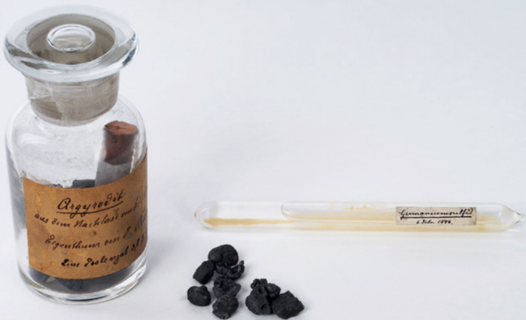
Abb. 7: Winklers erste Fällung von Germaniumsulfid mit Probe des Argyrodits, Sammlung anorganisch-chemischer Präparate, TU Bergakademie Freiberg, Foto: Michael Schwan
