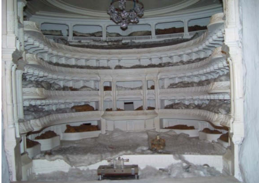
Abbildung 1 Raumakustisches Modell der historischen Semperoper (Maßstab 1:20)
