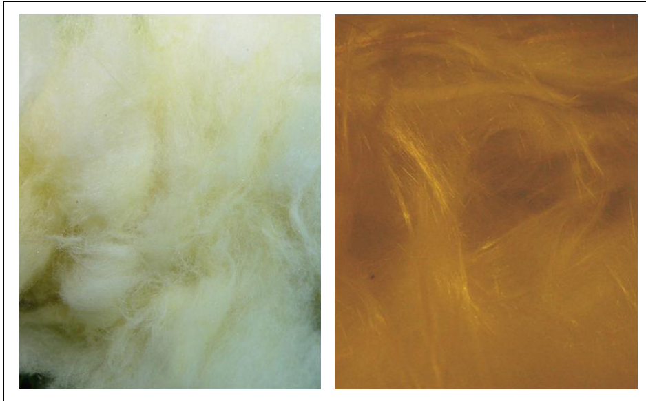
Abbildung 1 Schallabsorbermatten aus fasrigem Material
