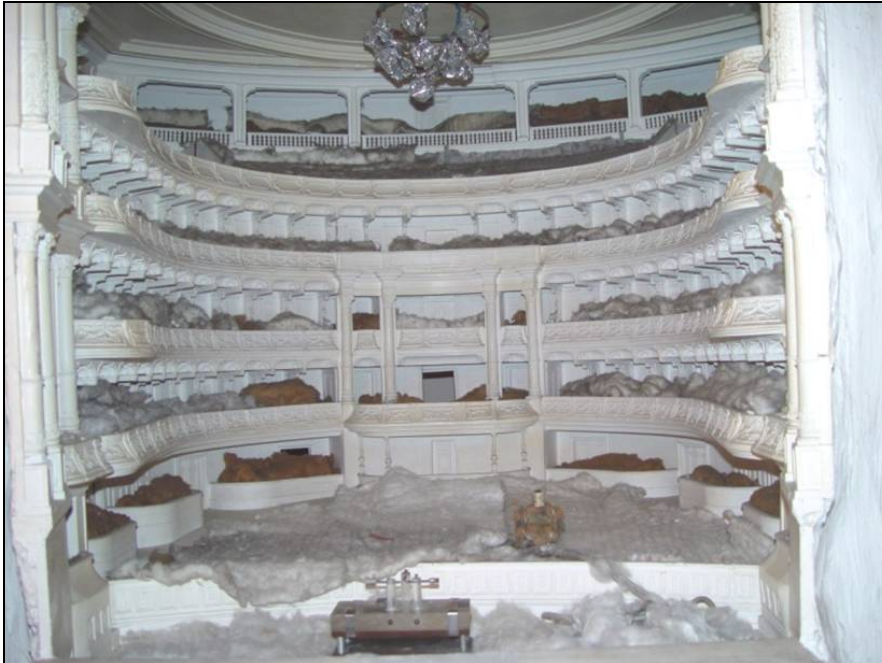
Abbildung 7 Raumakustisches Modell der historischen Semper-Oper (Institut für Akustik und Sprachkommunikation, TU Dresden)
