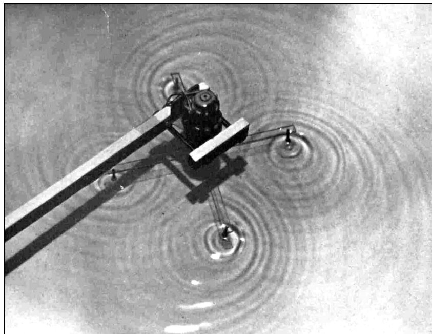
Abbildung 20 Schallabstrahlung eines Hubschrauberrotors im Unterschallbereich, Anwendung der Wasserwellenanalgie (nach Wright)
