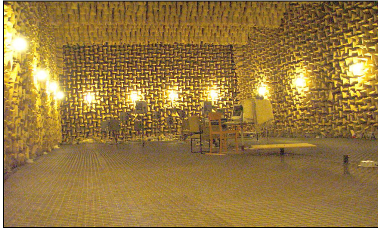
Abbildung 21 Großer schallreflexionsarmer Raum mit synthetischem Schallfeld (Institut für Akustik und Sprachkommunikation, TU Dresden)
