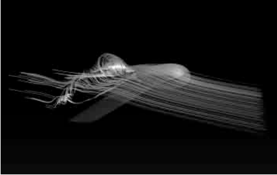
Abb. 1: Strömung um einen Flugzeugflügel. Simulation: Frank Thiele, TU Berlin. Visualisierung: Tino Weinkauff, ZIB. Siehe auch Farbtafel I.
